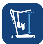
Løfteområdet med kort og lang innstilling av løftebom ▼
